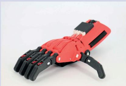
Réalisation d'un prototype avec une imprimante 3D
